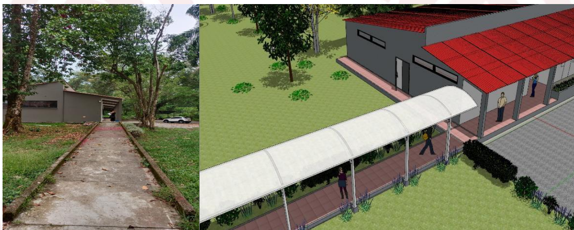
Figura 28. Instalación de piso de Gress y Domo en acrílico para comunicar el bloque 1 y 2
